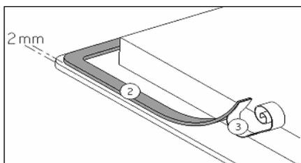
Kleben Sie die Dichtung (2) zwei Millimeter vom äußeren Rand des Glases entfernt, nachdem Sie die Schutzfolie entfernt haben (3).
